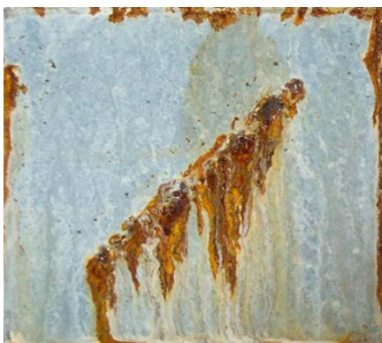
Obraz próbek przebywania w komorze solnej przez 9744 godziny. Test przeprowadzony wg. ASTM B117. Po lewej stronie powłoka wysokocynkowa DCC, po prawej stronie tej samej grubości powłoka galwanizowana.
