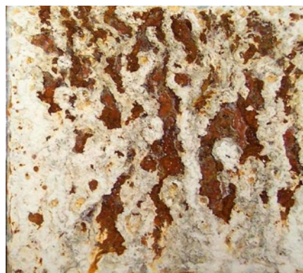
Obraz próbek przebywania w komorze solnej przez 9744 godziny. Test przeprowadzony wg. ASTM B117. Po lewej stronie powłoka wysokocynkowa DCC, po prawej stronie tej samej grubości powłoka galwanizowana.
