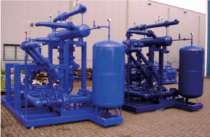
Greco Machinery – D (wchodzi w skład GEA), system DCC do aplikacji bezpośrednio na stal, oparty na 176i2 PoluRan i2 DTM. Aplikacja i utwardzanie normalnych warunkach bez przyspieszania procesu schnięcia w komorach wygrzewających. Po 2 godzinach od wymalowania możliwy montaż wszystkich elementów w całość oraz osiągnięta suchość transportowa dla całej zmontowanej konstrukcji.
